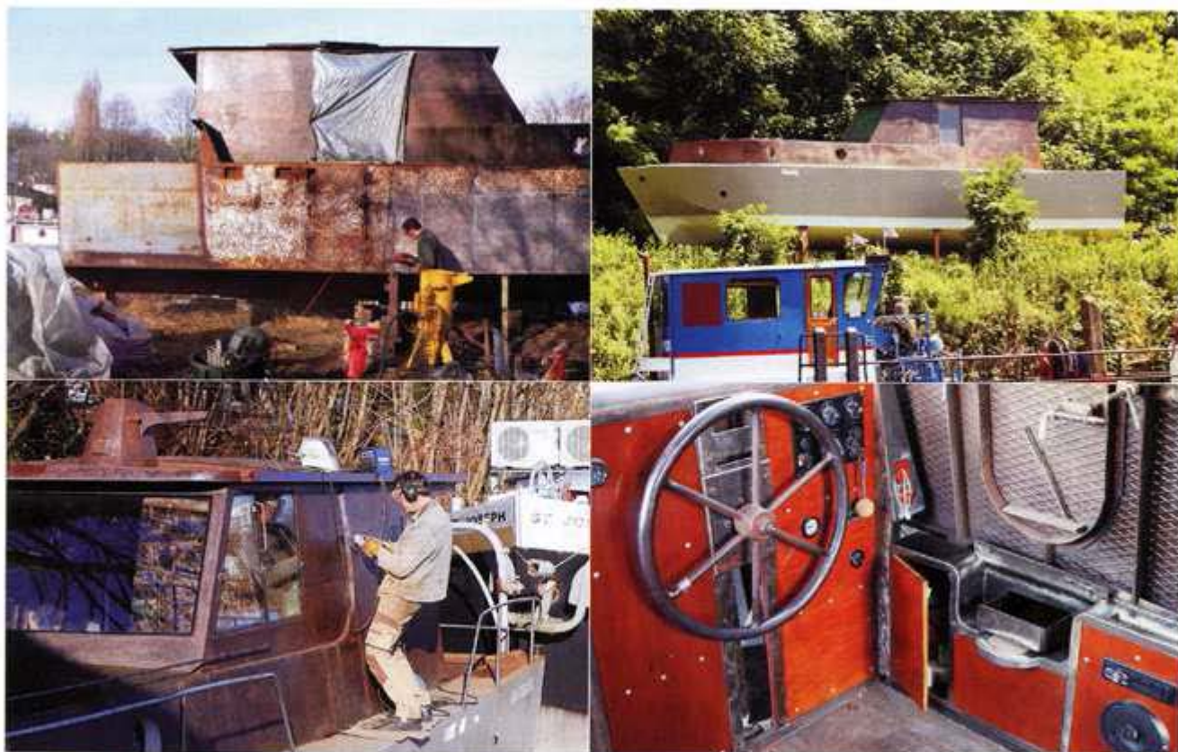
1 - Sablage de la coque. 2 - Samuel Mathey profite du beau temps pour peindre la coque avec de la peinture époxy. 3 - Reprise d'anciennes soudures montantes, les plus dures ! 4 - Poste de commande, mélange choisi de bois et d'acier vernis. Tirail secret pour optimiser l'espace.
